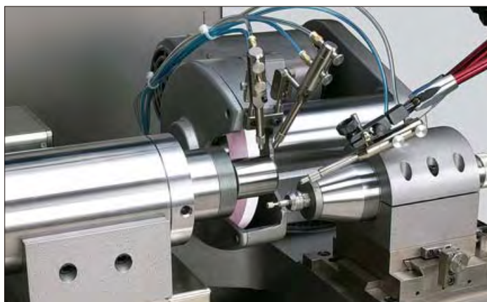
外研用砥石ユニットの研削例
