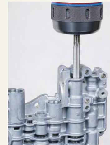
自動車部品の穴の仕上加工 Reaming of automotive parts
