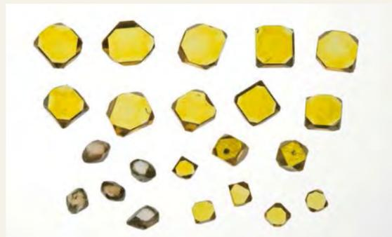
人工単結晶ダイヤモンド素材 Synthetic single-crystal diamond
